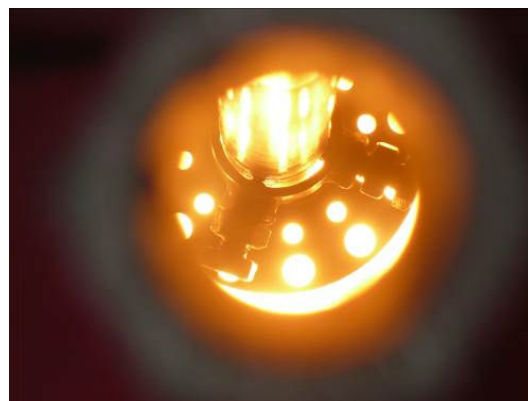
Spalanie smoły – widok końcówki palnika
